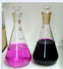
Certains sables naturels (*par exemple le MTM ou le GREENSAND*) nécessitent une **régénération** afin de renouveler leur pouvoir d'oxydation du Fer et du Manganèse. Pour cela l'utilisation d'un oxydant puissant comme le **permanganate de potassium** est nécessaire.
